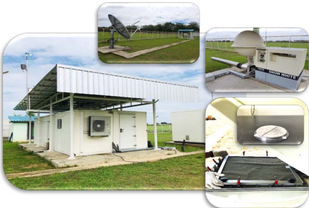
รูปที่ 4 สถานีเฝ้าตรวจนิวไคลด์กัมมันตรังสี อาร์ เอ็น 65 พร้อมเครื่องเก็บตัวอย่างฝุ่นละอองในอากาศ
