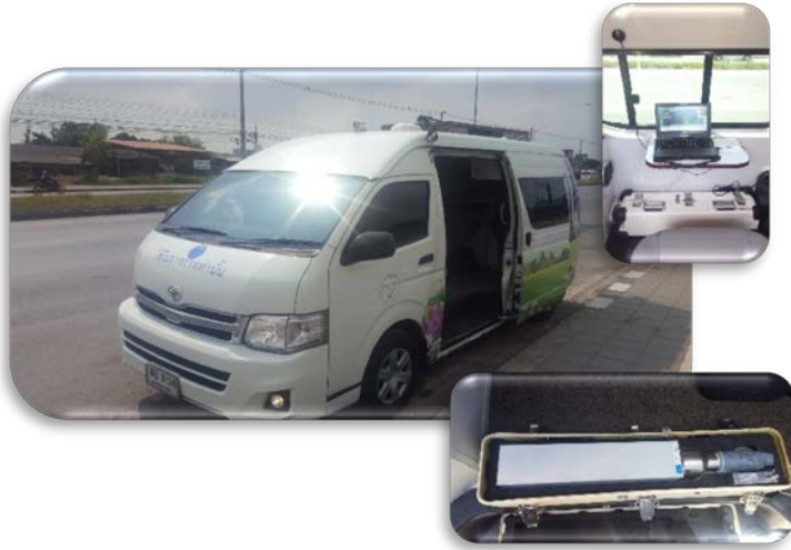
รูปที่ 8 รถปฏิบัติการตรวจวัดกัมมันตภาพรังสีในสิ่งแวดล้อม พร้อมระบบวัดระดับรังสีแกมมาในอากาศแบบเรียลไทม์
