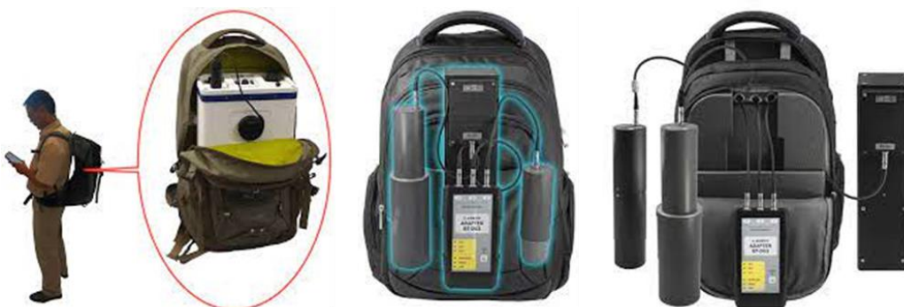
รูปที่ ๒-๑๒ แสดงตัวอย่างเครื่องวัดทางรังสีแบบกระเป๋าสะพายหลัง
