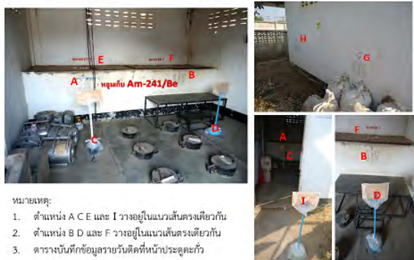
ตำแหน่งการติดตั้งแผ่น CR-39 ณ ห้องเก็บวัสดุกัมมันตรังสี Am-241/Be
