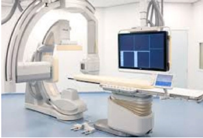
รูปที่ 18 เครื่องเอกซเรย์ระบบหลอดเลือด ( https://www.philips.co.uk/healthcare/product/HC722014/allura-xper-fd-20-20#galleryTab=PI )
