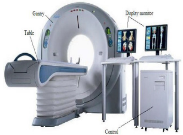
รูปที่ 19 เครื่องเอกซเรย์คอมพิวเตอร์ ( http://www.med.cmu.ac.th/dept/radiology/324321%5Cx_ray_vet321_55[1].pdf )
