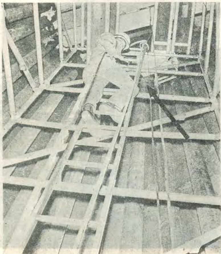
ทำ Radiography ที่รอยเชื่อมข้ออกภายใน Hydrotreater Heater, ใช้ Cs-137
