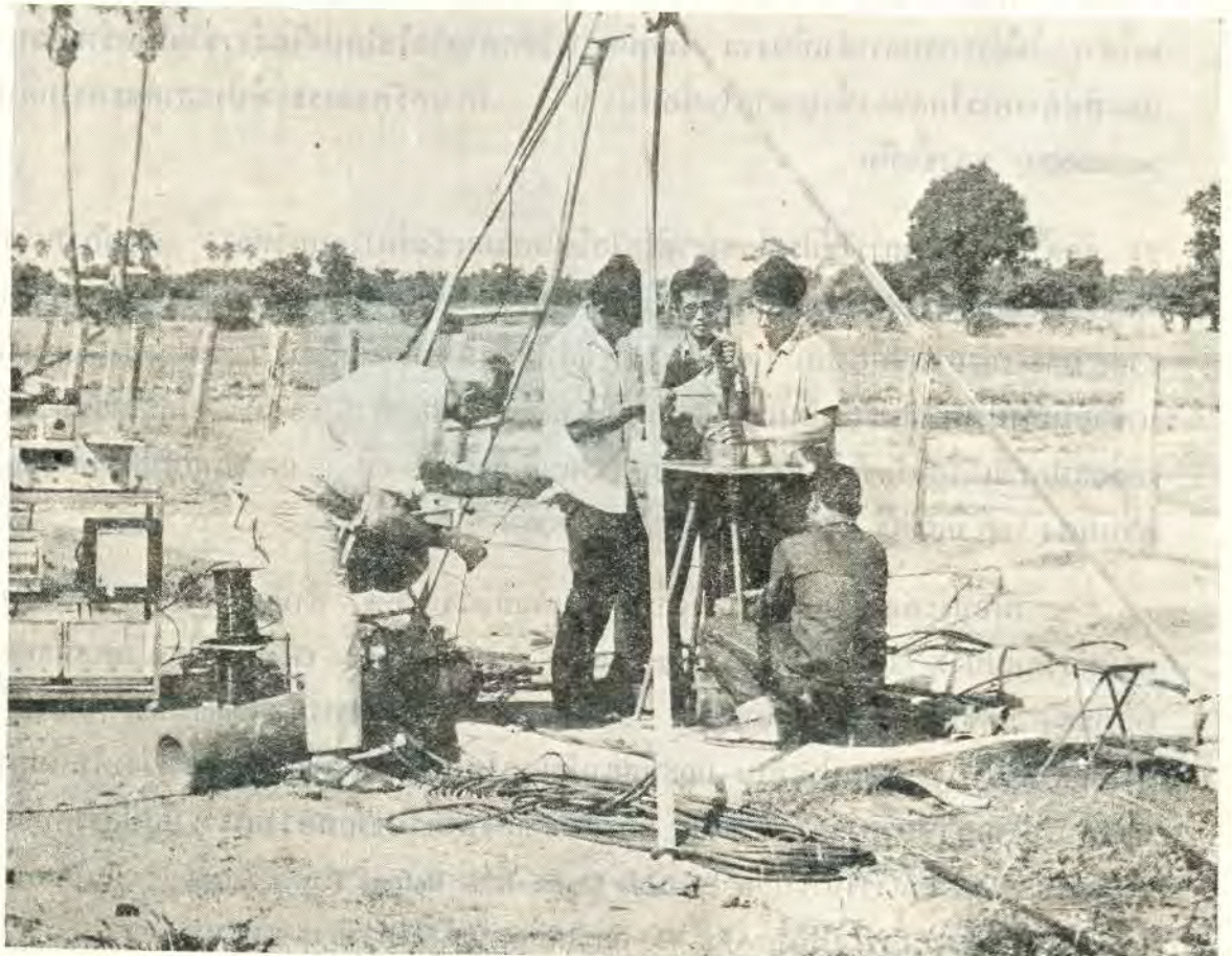
ภาพบน : หย่อนหัววัดลงบ่อน้ำบาดาล วัดความเร็วของน้ำใต้ดิน ภาพล่าง : ประกอบอุปกรณ์วัดทิศทางการไหลของน้ำใต้ดินที่บ่อน้ำบาดาล
