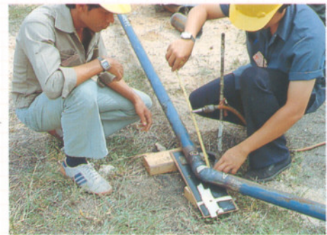
ลักษณะขั้นตอนการถ่ายภาพด้วยรังสี แนวเชื่อมท่อ้ำมันภาคสนาม
