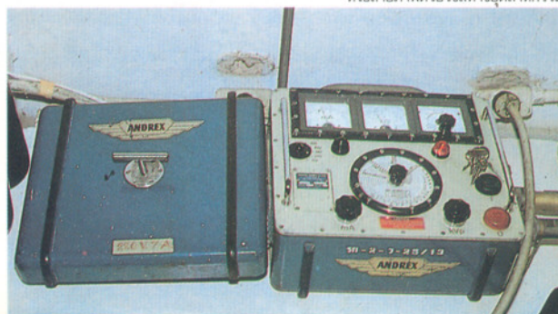
เครื่องมือควบคุมการป้องกันกระแสไฟฟ้าให้กับหลอดกำเนิดรังสีเอกซ์ ที่ใช้ถ่ายภาพด้วยรังสีทางอุตสาหกรรม
