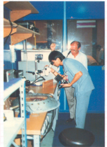
ขั้นตอนการวินิจฉัยผลของสิ่งบกพร่องในวงล้อของเครื่องบินโดยสาร
