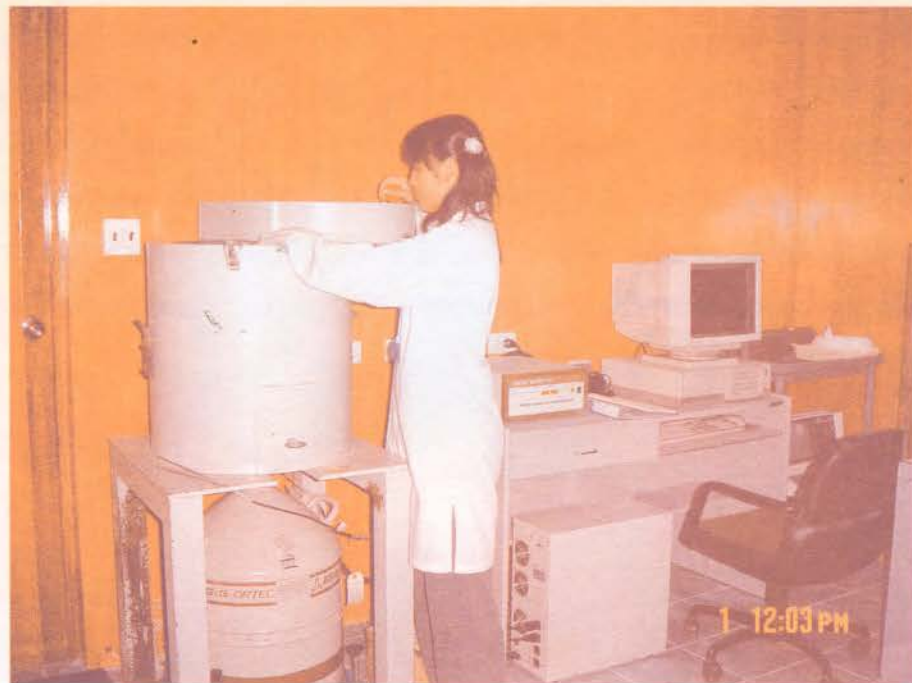
รูปที่ 2 การวิเคราะห์ปริมาณธาตุด้วยเทคนิค Instrumental Neutron Activation Analysis (INAA) โดยอาศัยระบบวัด Gamma Spectroscopy
