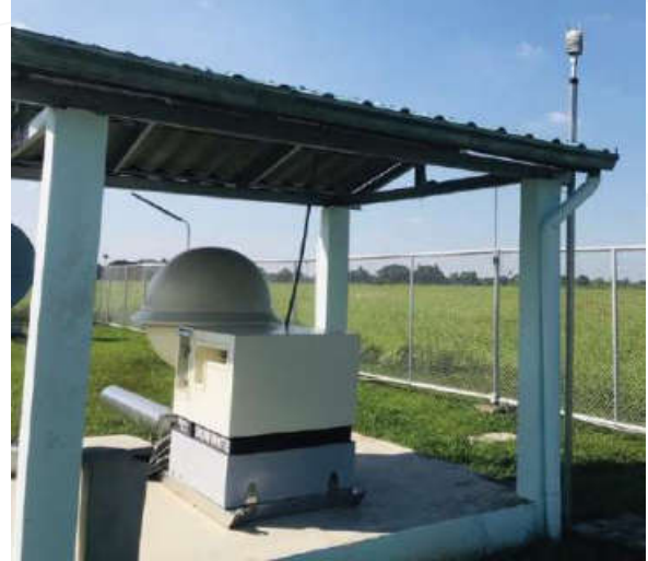
ระบบการเก็บตัวอย่างและระบบตรวจวัดอุณหภูมิ และความชื้นภายนอกอาคาร (สถานีเฝ้าตรวจนิวไคลด์กัมมันตรังสี อาร์เอ็น65)
