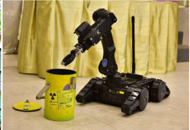
หุ่นยนต์เก็บกู้สารกัมมันตรังสีในพื้นที่เกิดเหตุ กรณีเกิดเหตุซึ่งมีปริมาณรังสีที่เป็นอันตรายสูง ต่อเจ้าหน้าที่ผู้ปฏิบัติงาน
