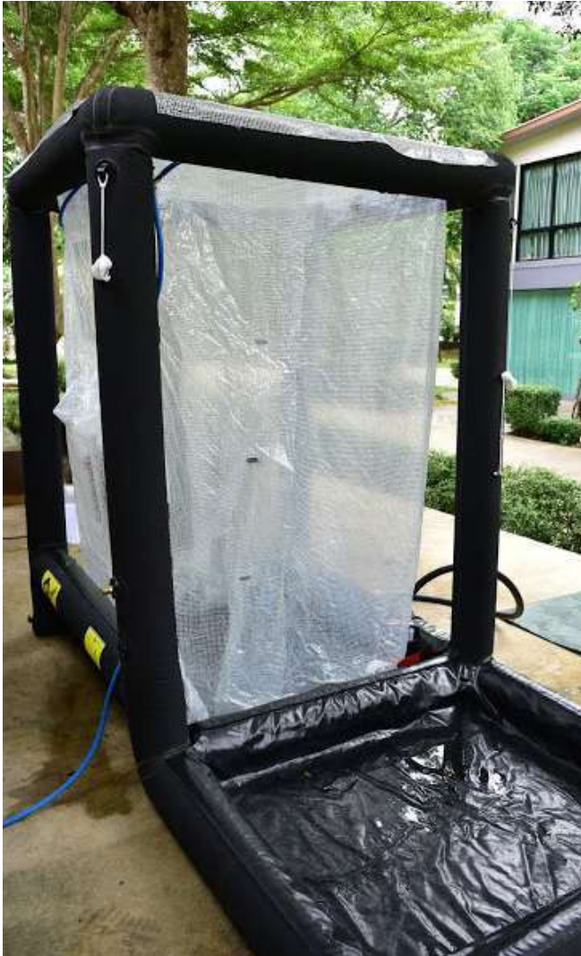
ห้องชำระล้างการประอะเปื้อนทางรังสีใช้ในการชำระล้างการประอะเปื้อนทางรังสีของผู้ปฏิบัติงานกรณีผู้ปฏิบัติงานในพื้นที่ได้รับการประอะเปื้อนทางรังสี
