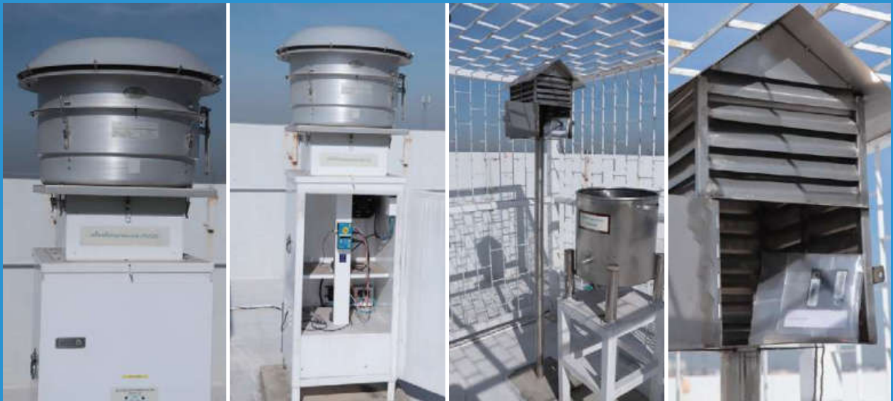
เครื่องเก็บตัวอย่างอากาศฝุ่นกับมันตรังสี
