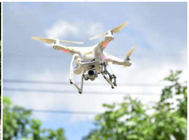
อากาศยานไร้คนขับพร้อมติดตั้งความละเอียดสูง พร้อมระบุพิกัดแผนที่ เพื่อประเมินสถานที่เกิดเหตุ เพื่อช่วยในการตัดสินใจวางแผนก่อนให้เจ้าหน้าที่เผชิญเหตุเข้าไปปฏิบัติหน้าที่
