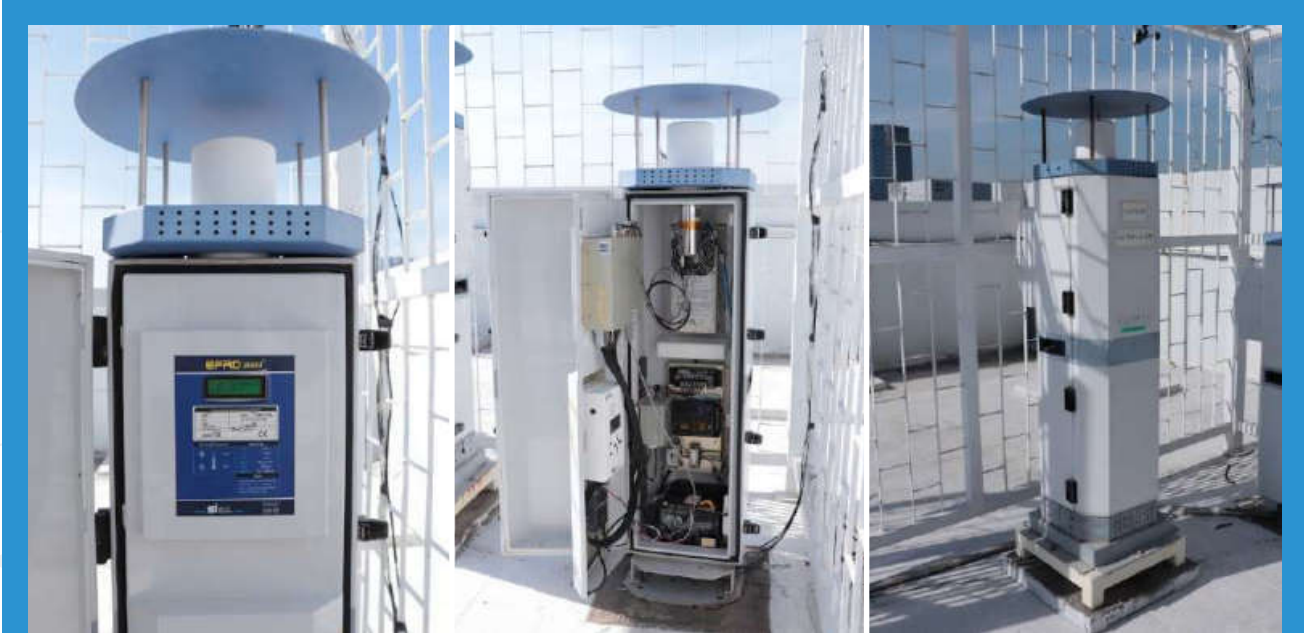
เครื่องวัดรังสีชนิดแยกนิวเคลอิดกับมันตรังสี (EFRD)
