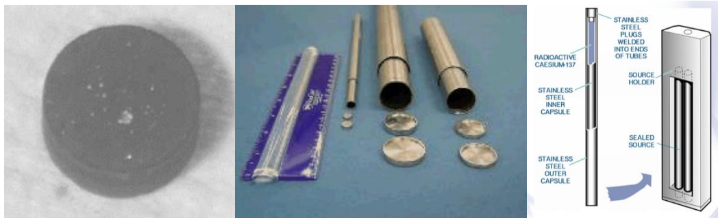
รูปที่ 5 วัสดุแกมมาต้นรังสีซีเซียม-137 และแคปซูลสแตนเลส
