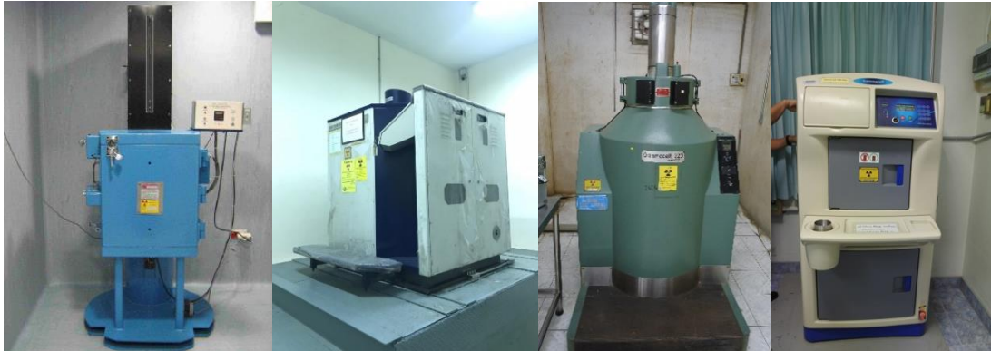
รูปที่ 1 ตัวอย่างเครื่องฉายรังสีแกมมาที่วัสดุกัมมันตรังสีมีเครื่องกำบังรังสีในตัว ที่มารูป https://www.irpa.net/members/P06.84fp.pdf
