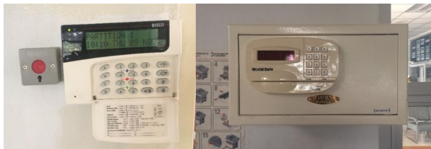
รูปที่ 4 แสดงตัวอย่างอุปกรณ์ Keypad สำหรับการอนุญาตให้เข้าถึง และผู้ควบคุมการเบิกจ่ายกุญแจ
