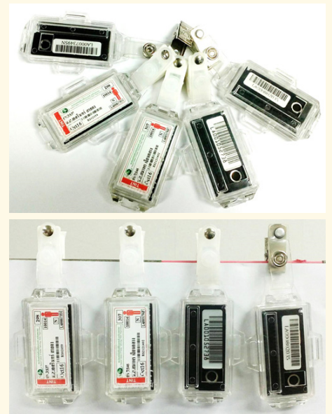
อุปกรณ์วัดรังสีประจำบุคคล OSL (Optically stimulated luminescence)
