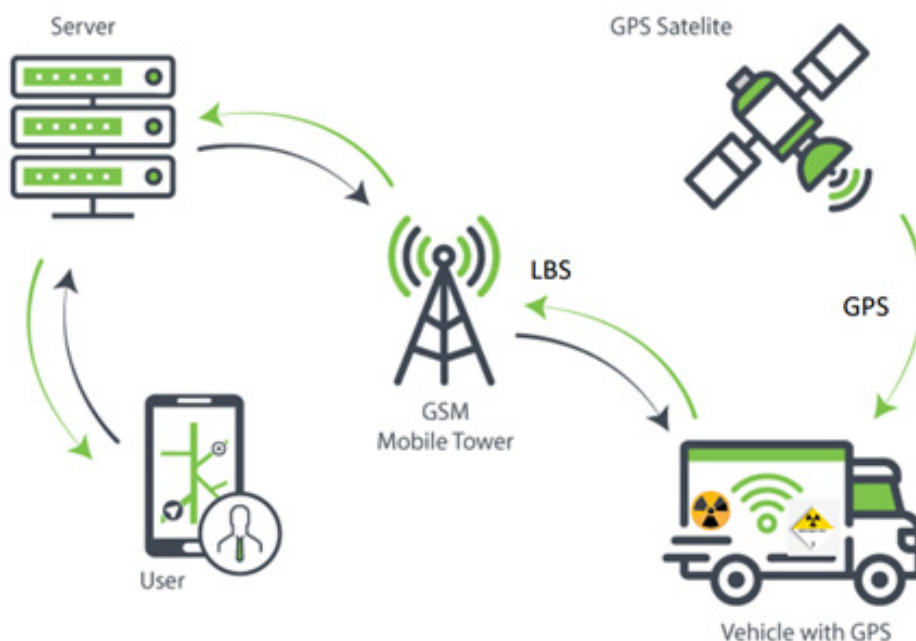
ภาพแสดงหลักการพื้นฐานของระบบติดตามการขนส่งวัสดุกัมมันตรังสี
