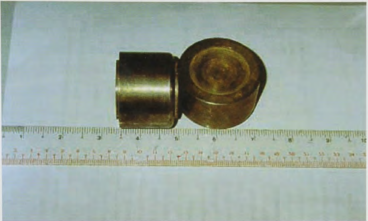
รูปที่ 4 วัตถุรูปทรงกระบอกซึ่งเคยเป็นที่ท่อหุ้มวัสดุกัมมันตรังสีโคบอลต์-60 (วัตถุทางซ้ายมีรูกลวง ด้านกำเนิดรังสีโคบอลต์-60 บรรจุอยู่ภายใน)
