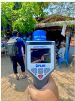
การตรวจวัดระดับรังสีบริเวณที่พักอาศัย ด้วยเครื่อง Identifinder-ER
