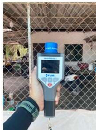
การตรวจวัดระดับรังสีบริเวณที่พักอาศัย ด้วยเครื่อง Identifinder-ER
