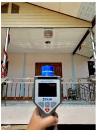
การตรวจวัดระดับรังสีบริเวณที่พักอาศัย ด้วยเครื่อง Identifinder-ER
