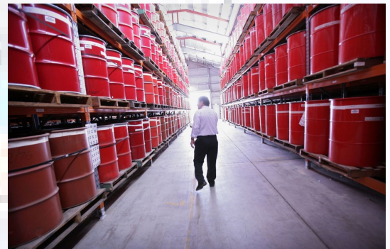
การเก็บวัสดุกัมมันตรังสีเพื่อรอการสลายตัว
