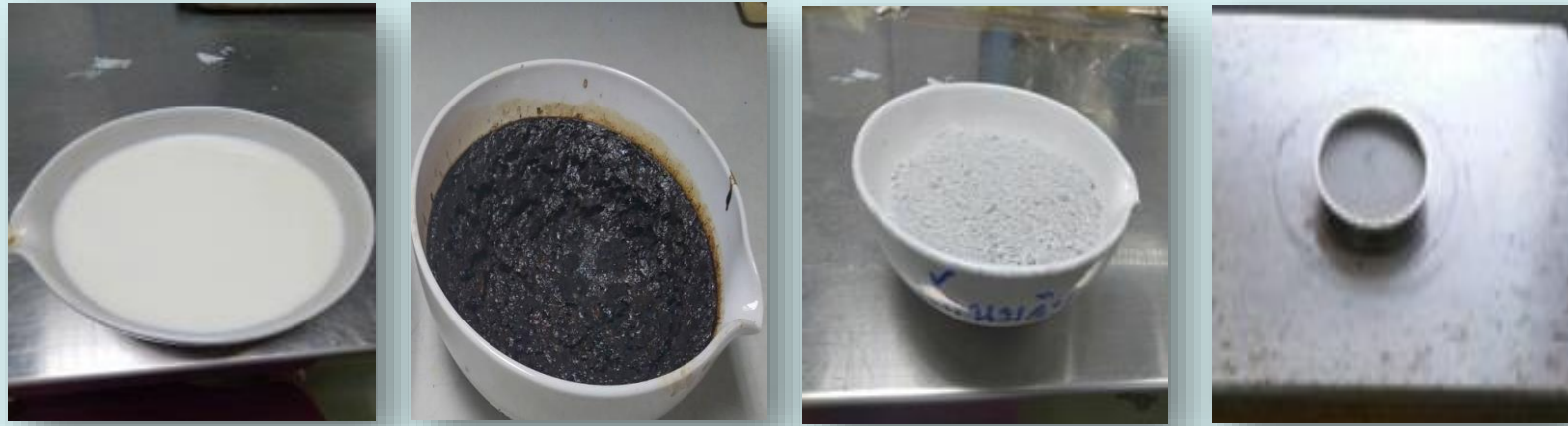
รูปที่ 3 แสดงลำดับขั้นตอนการเตรียมตัวอย่างขี้เถ้านมก่อนนำไปวัดปริมาณรังสีบีตารวม
