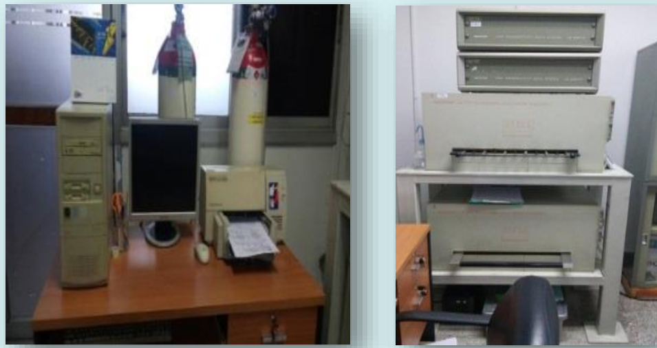
รูปที่ 4 เครื่องวัดปริมาณรังสีแอลฟา-บีตารวมชนิด Gas flow proportional counter
