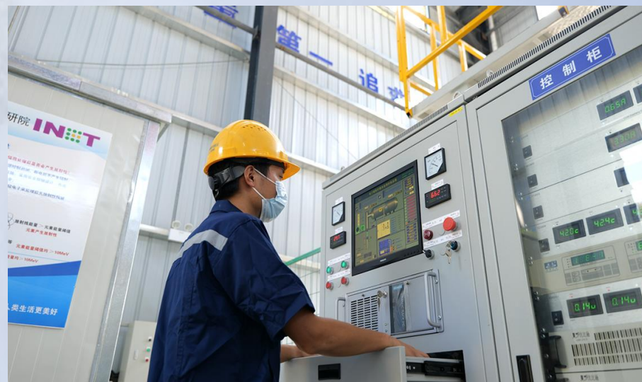
รูปที่ 2: ช่างเทคนิคเดินเครื่องเร่งอนุภาคอิเล็กตรอนผลิตลำรังสีอิเล็กตรอนพลังงานสูงไปทำปฏิกิริยากับโมเลกุล DNA/RNA หรือเซลล์ของจุลินทรีย์
