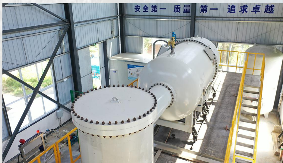
รูปที่ 1: เครื่องเร่งอนุภาคอิเล็กตรอนแบบมีเครื่องกำบังรังสีในตัวเองสำหรับฉายรังสีน้ำเสียทางการแพทย์
