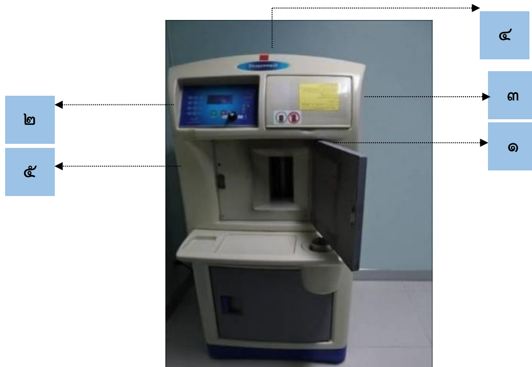
รูปที่ 3 แสดงตัวอย่างรูปเครื่องฉายรังสีทางการแพทย์ และกำหนดตำแหน่งการวัดระดับรังสี
