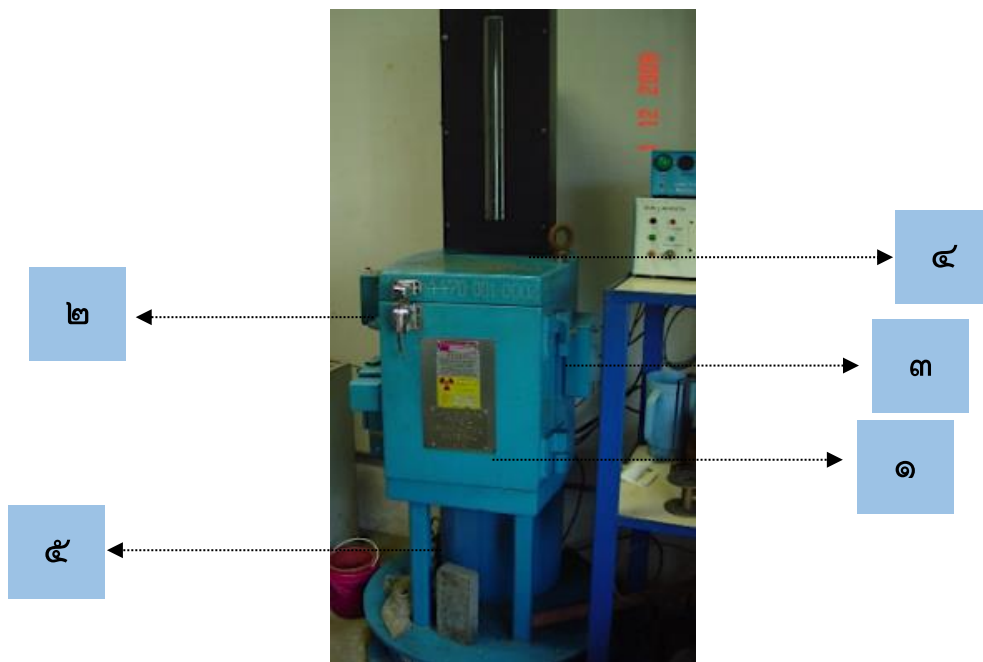
รูปที่ 2 แสดงตัวอย่างรูปเครื่องฉายรังสีแกมมา มาร์ค วัน รุ่น Mark I 30 และกำหนดตำแหน่งการวัดระดับรังสี
