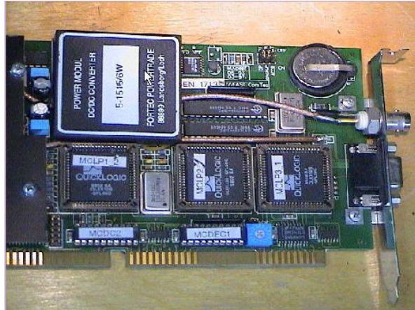
อุปกรณ์วิเคราะห์แบบหลายช่องชนิด PCA card
