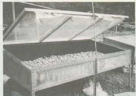
รูปที่ 5 ตู้อบมะขามหวานด้วยพลังงานแสงอาทิตย์
