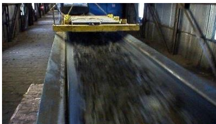
รูปที่ 5.15 : เครื่องตรวจจับรังสีในรูปแบบการตรวจจับบนสายพาน
