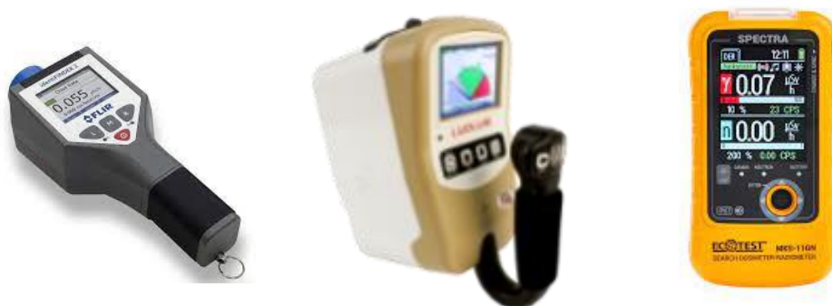
รูปที่ 5.19 : เครื่องตรวจจับรังสีในรูปแบบ Isotope Identifier Meter
