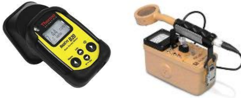
รูปที่ 5.20 : เครื่องตรวจจับรังสีในรูปแบบ Contamination Survey Meter
