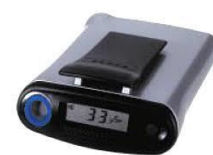
รูปที่ 5.16 : เครื่องตรวจจับรังสีในรูปแบบ Extended Reach Survey Meter
