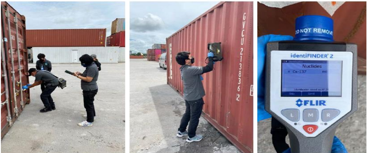
รูปที่ 5.4 : การตรวจวัดปริมาณรังสีตู้สินค้าของบริษัท A
