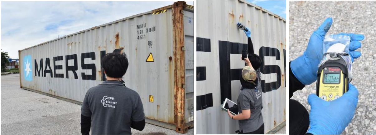
รูปที่ 5.5 : การตรวจวัดปริมาณรังสีตู้สินค้าของบริษัท B
