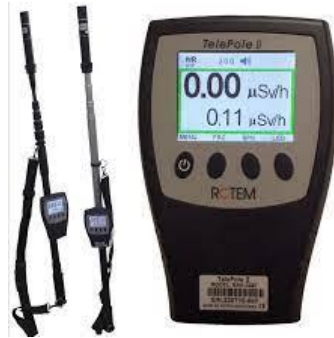
รูปที่ 5.17 : เครื่องตรวจจับรังสีในรูปแบบ Extended Reach Survey Meter
