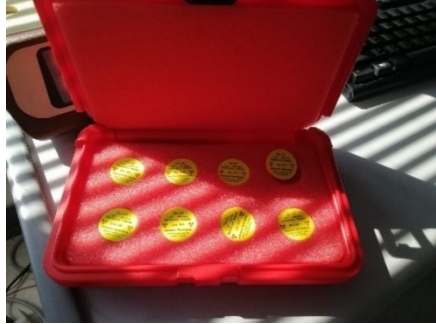
รูปที่ 3 ตัวอย่างแหล่งกำเนิดรังสีมาตรฐานที่ใช้ในการเปรียบเทียบพลังงาน
