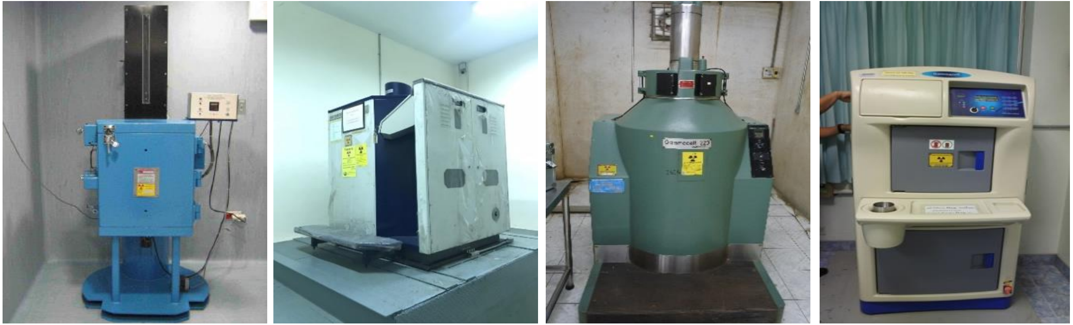
รูปที่ 1 ตัวอย่างเครื่องฉายรังสีแกมมาที่วัสดุกันมันตรังสีมีเครื่องกำบังรังสีในตัว ที่มา https://www.irpa.net/members/P06.84fp.pdf
