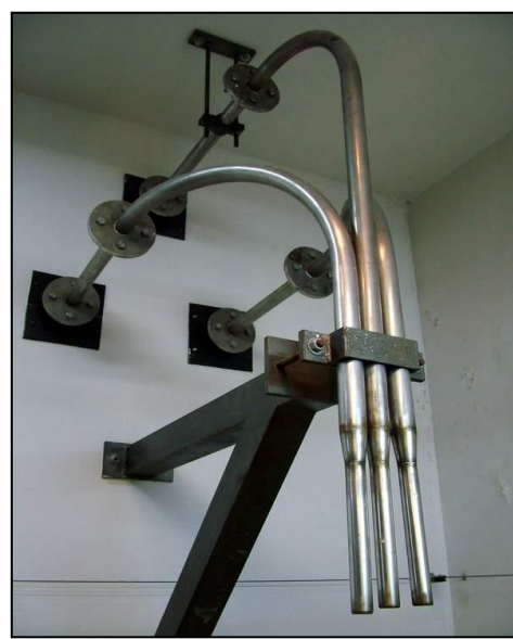
รูปที่ 4 ตัวอย่างเครื่องฉายรังสีแกมมาที่มีวัสดุกัมมันตรังสีขณะฉายอยู่ภายนอกเครื่องกำบัง แบบ Panoramic Dry Source Storage Irradiators
