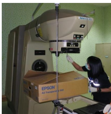
รูปที่ 4 แสดงการตรวจสอบการร้าวทางรังสี กรณีเครื่องฉายรังสีรักษาระยะไกล (Teletherapy)
