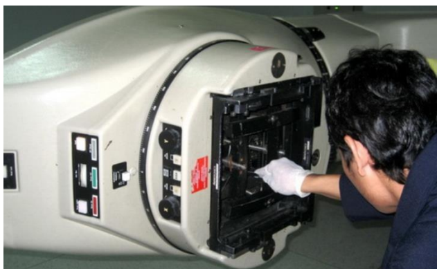
รูปที่ 4 แสดงการตรวจสอบการร้าวทางรังสี กรณีเครื่องฉายรังสีรักษาระยะไกล (Teletherapy)
