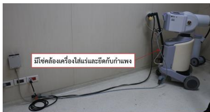
รูปที่ 3 การติดตั้งอุปกรณ์ยึดเครื่องใส่แร่ไม่ให้อุปกรณ์เคลื่อนย้ายได้ง่าย
