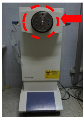
รูปที่ 5 แสดงการตรวจสอบการร้าวทางรังสี กรณีเครื่องใส่แร่ (Brachytherapy)
