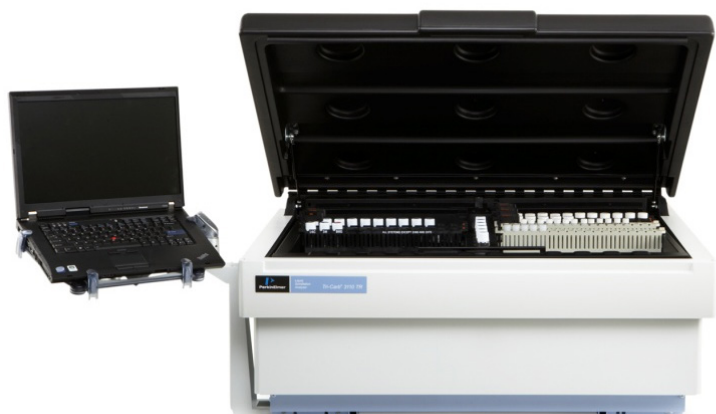
ภาพ แสดงการตรวจวัดตัวอย่างในเครื่องวัดรังสีจากแสงวับ
