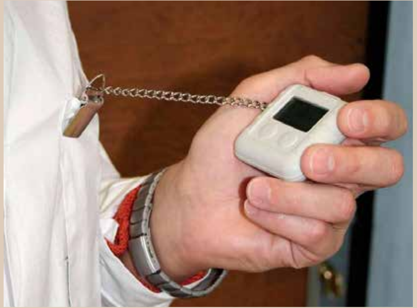
เครื่องวัดรังสีชนิดเสียบกระเป๋าสสามารถอ่านค่าได้ทันที เหมาะสำหรับวัดระดับรังสีระหว่างการทำงาน
