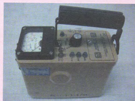
เครื่องมือวัดรังสี (Survey meter)
