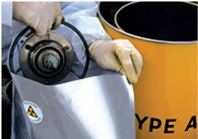
รูปที่ 3 ขั้นตอนการจัดการสายล่อฟ้าที่มีวัสดุกัมมันตรังสีหลังเลิกใช้งานแล้ว
